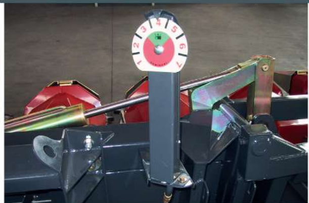
Датчик состояния пластин отрывателя регулирует зазор между пластинами отрывателя
