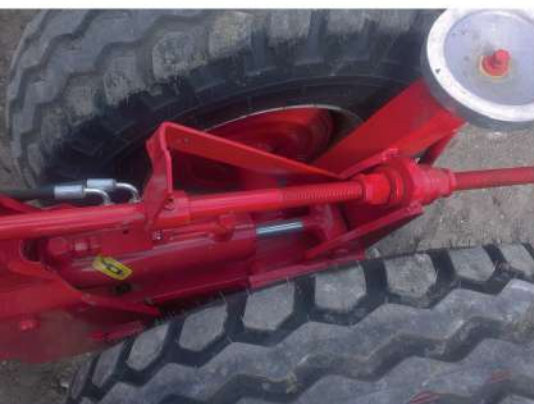
Гидравлический регулятор наклона - для поднятия лезвия с одной стороны, и финальной обработки в углах
