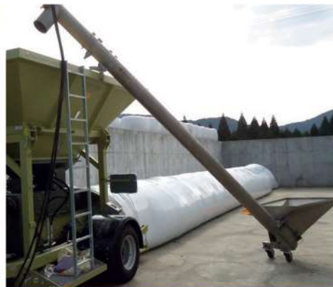
Приемный шнековый конвейер позволяет наполнить бункер без использования погрузчика
