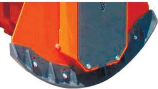
Глубина заглабления серии F - 70 мм
