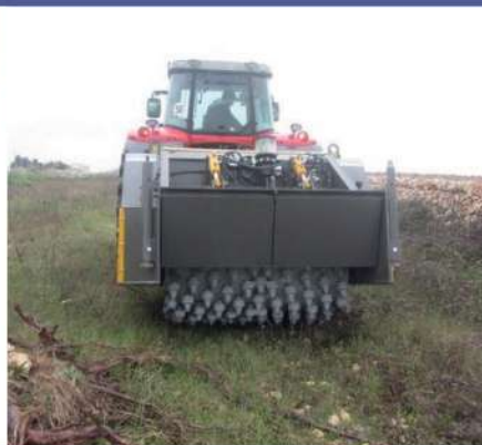
Ротор расположен ниже плоскости опор оборудования
