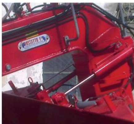
Гидравлический привод угла наклона ножа экономит мощность трактора и создает нужный градус уклона поверхности
