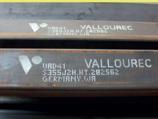
Прочность конструкции обеспечена: прессованной сталью, высокоустойчивыми трубами холодного и горячего проката (S35512H), усиленной основной рамой
