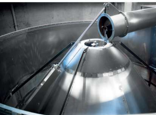
Центральный шнек с наплавкой из стали Hardox
