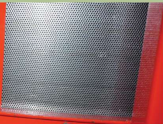
Универсальная сетка бункера с перфорацией 1.5 мм
