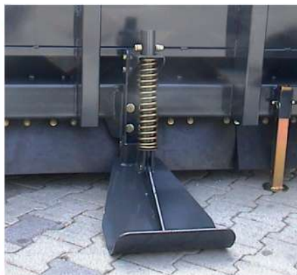
Плющилка стебля позволяет избежать повреждения шин комбайна стерней
