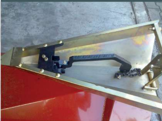
Детектор уровня почвы обеспечивает минимальную высоту жатки над поверхностью почвы
