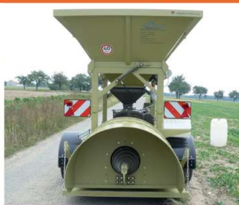
Пружинное шасси обеспечивает транспортировку плющилки со скоростью до 40 км/ч
