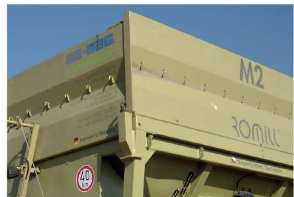
Корпус увеличивает объем бункера до 9 м 3
