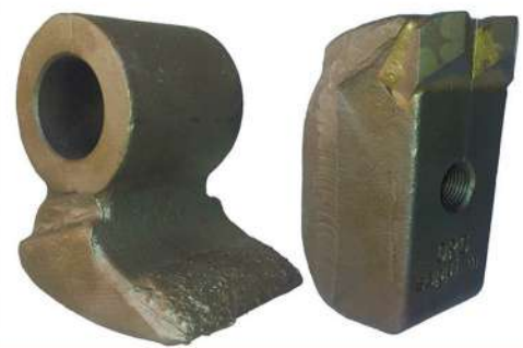
Резцы с карбидовыми напайками
