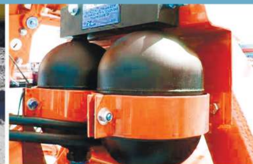
Охлаждение гидравлики, азотный аккумулятор
