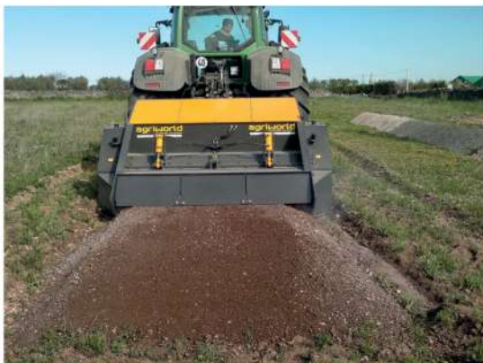
Трамбующие пластины для выравнивания поверхности обработанной земли
