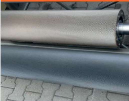
Вальцы изготавливаются с применением технологии нитрирования стали
