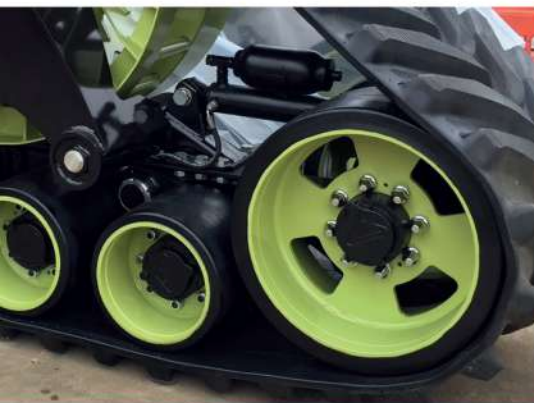
Прорезиненные ролики и натяжители обеспечивают более длительный срок службы
