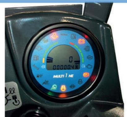
ГРАФИЧЕСКИЙ ЖК-ДИСПЛЕЙ С ПРОГРАММИРОВАНИЕМ (ТАХОМЕТР, СЧЕТЧИК ЧАСОВ, УКАЗАТЕЛЬ УРОВНЯ ТОПЛИВА, ИНДИКАТОР ОБСЛУЖИВАНИЯ, И ЕЩЕ 14 ИНДИКАТОРОВ)
