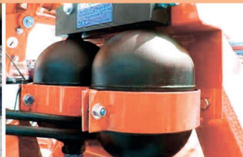
ОХЛАЖДЕНИЕ ГИДРАВЛИКИ, АЗОТНЫЙ АККУМУЛЯТОР
