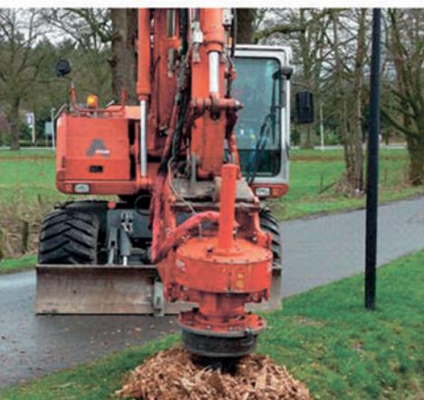
АГРЕГАТИРОВАНИЕ НА СТРЕЛУ ЭКСКАВАТОРА, РАБОТАЕТ ОТ ГИДРОСИСТЕМЫ
