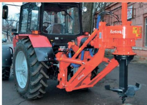
АГРЕГАТИРОВАНИЕ ЧЕРЕЗ 3-Х ТОЧЕЧНУЮ СИСТЕМУ КРЕПЛЕНИЯ ТРАКТОРА, РАБОТАЕТ ОТ ВОМ
