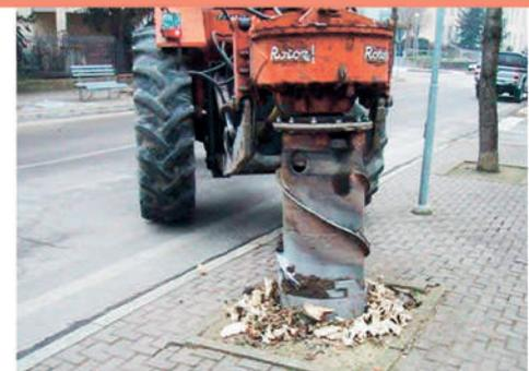
ЦИЛИНДРИЧЕСКИЙ РАБОЧИЙ ОРГАН ДЛЯ ИЗВЛЕЧЕНИЯ СТЕРЖНЯ ПНЯ
