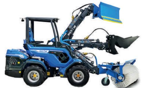
УНИВЕРСАЛЬНОЕ СЦЕПНОЕ УСТРОЙСТВО И ГИДРАВЛИЧЕСКИЕ МУЛЬТИКОННЕКТОРЫ ПОЗВОЛЯЮТ БЫСТРО МЕНЯТЬ РАБОЧИЕ ОРГАНЫ
