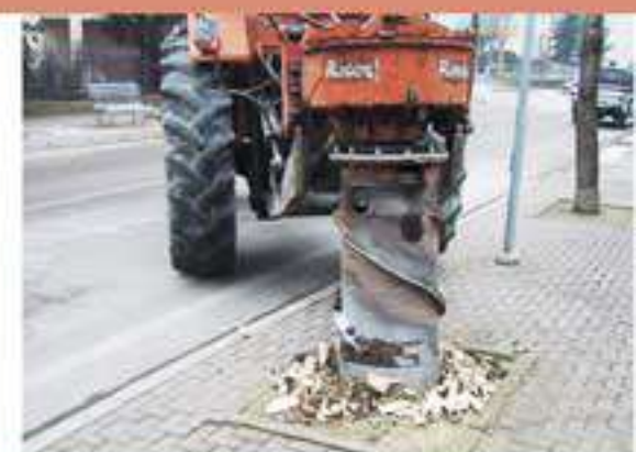
ЦИЛИНДРИЧЕСКИЙ РАБОЧИЙ ОРГАН ДЛЯ ИЗВЛЕЧЕНИЯ СТЕРЖНЯ ПНЯ
