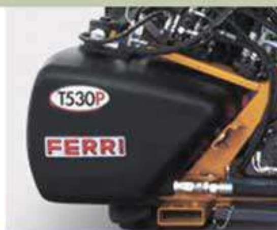
ГИДРОБАК ИЗ ПОЛИМЕРОВ LLDPE ДЛЯ ОБЛЕГЧЕНИЯ КОНСТРУКЦИИ
