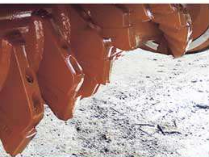
ФИКСИРОВАННЫЕ ЗУБЬЯ С ДВОЙНЫМИ КРЕПЛЕНИЯМИ
