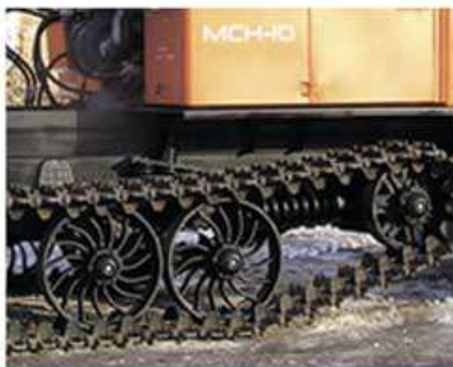
РЫЧАЖНО – БАЛАНСИРНАЯ ПОДВЕСКА
