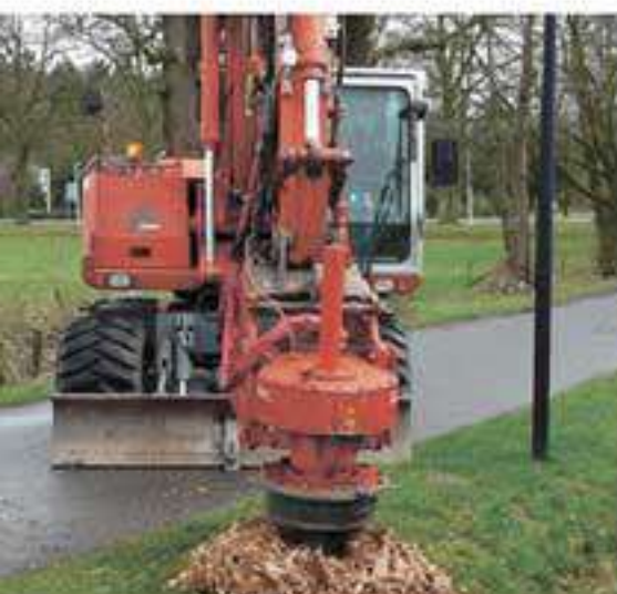
АГРЕГАТИРОВАНИЕ НА СТРЕЛУ ЭКСКАВАТОРА, РАБОТАЕТ ОТ ГИДРОСИСТЕМЫ
