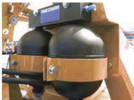
ОХЛАЖДЕНИЕ ГИДРАВЛИКИ, АЗОТНЫЙ АККУМУЛЯТОР
