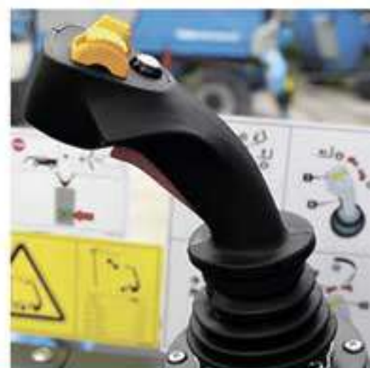
ДЖОЙСТИКОВОЕ УПРАВЛЕНИЕ НАВЕСНЫМ ОБОРУДОВАНИЕМ И СПЕЦШАССИ
