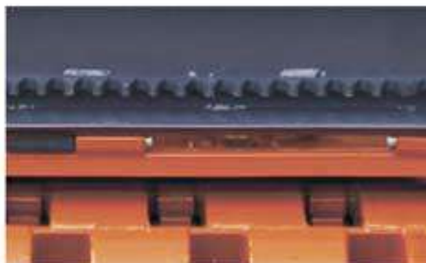
ЧЕТЫРЕ РЯДА КОНТРОНОЖЕЙ ДЛЯ ПОЛУЧЕНИЯ МИНИМАЛЬНОЙ ФРАКЦИИ МУЛЬЧИ ЗА ОДИН ПОДХОД
