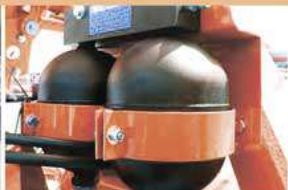
ОХЛАЖДЕНИЕ ГИДРАВЛИКИ, АЗОТНЫЙ АККУМУЛЯТОР
