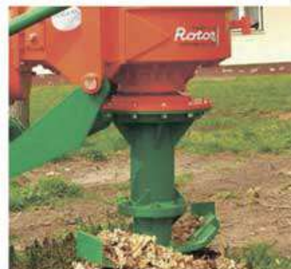
РОТОРНЫЙ РАБОЧИЙ ОРГАН ДЛЯ ИЗМЕЛЬЧЕНИЯ ПНЯ И КОРНЯ В ГРУНТЕ
