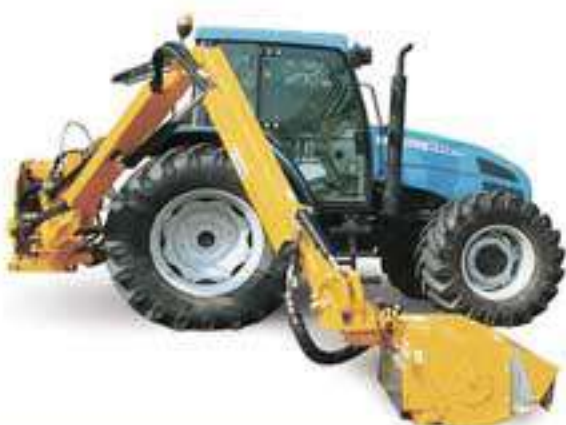
ИЗОГНУТАЯ СТРЕЛА ДЛЯ УДОБСТВА КОНТРОЛЯ ОПЕРАТОРОМ ХОДА РАБОТ
